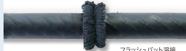
フラッシュバット溶接
